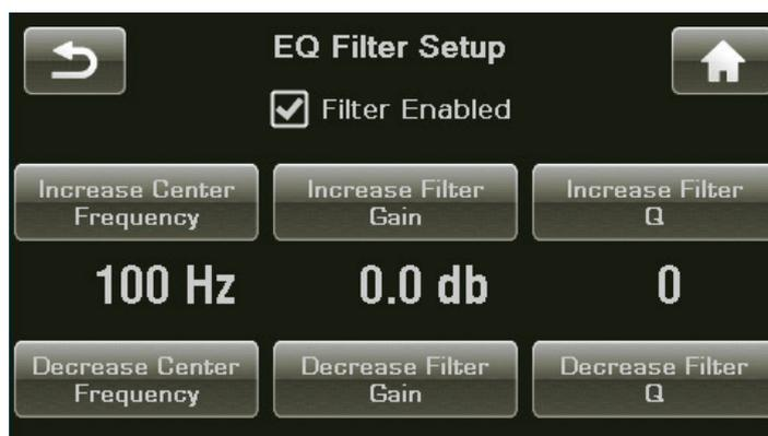
Vous n'avez pas besoin d'activer tous les filtres ni aucun filtre pour chaque canal. Il suffit à l'installateur d'ajuster les canaux nécessaires pour corriger l'interaction de la pièce. *Nous vous encourageons à consulter votre revendeur agréé Classé pour calibrer correctement la fonction d'égalisation paramétrique.*
