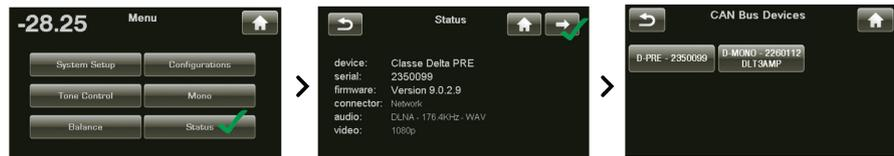
La sélection d'un appareil sur l'écran des périphériques à bus CAN l'identifie comme appareil cible.
