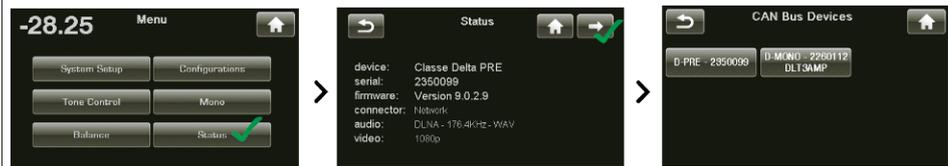
Durch Auswählen eines Geräts auf dem CAN-Bus-Geräte-Bildschirm wird das entsprechende Gerät als **Zielgerät** identifiziert. Die LED(s) oder das VU-Meter an der Vorderseite des Zielgeräts beginnen zu blinken (es sei denn, Sie wählen das Gerät, mit dem Sie auf den CAN-Bus zugreifen).
