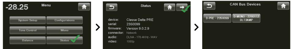
CAN-Bus 장치 화면에서 기기를 선택하면 대상 기기로 식별됩니다. 대상 기기의 전면 패널 LED 또는 미터 라이트가 깜박이기 시작합니다 (CAN-Bus에 액세스하는 데 사용하는 기기를 선택하지 않은 경우).
