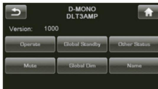
모델, 이름 및 펌웨어 버전 번호는 대상 기기의 CAN-Bus 페이지에 표시됩니다.
