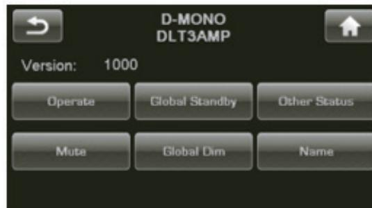
Das Modell, der Name und die Firmware-Versionsnummer werden auf der CAN-Bus-Seite des Zielgeräts angezeigt.
