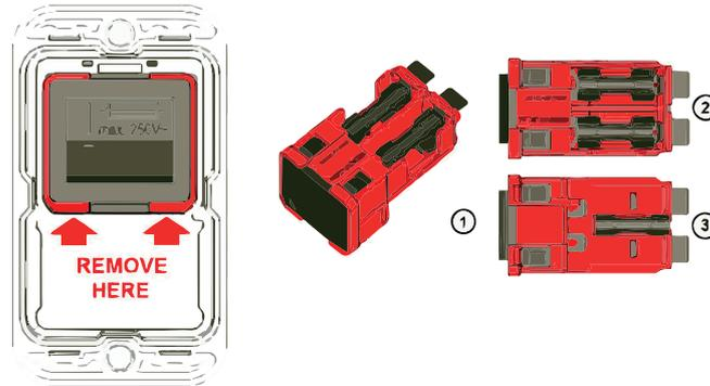
Une marque de fusible supplémentaire sur l'interrupteur indique les porte-fusibles situés derrière l'interrupteur. Le cadre rouge montre le contour de l'unité amovible.
