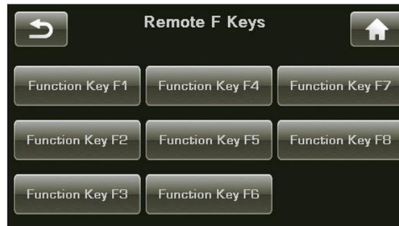
Die Tasten **F1** bis **F8** der Fernbedienung entsprechen den auf dem Touchscreen angezeigten Funktionstasten. Wählen Sie die **Funktionstaste** aus, die Sie zuweisen möchten, und scrollen Sie durch die Liste. Wählen Sie dann die spezifische Funktion aus, die über die **F-Taste** ausgeführt werden soll.
