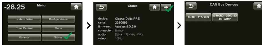
Durch Auswählen eines Geräts auf dem CAN-Bus-Geräte-Bildschirm wird das entsprechende Gerät als **Zielgerät** identifiziert.
