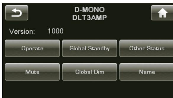
Das Modell, der Name und die Firmware-Versionsnummer werden auf der CAN-Bus-Seite des Zielgeräts angezeigt.
