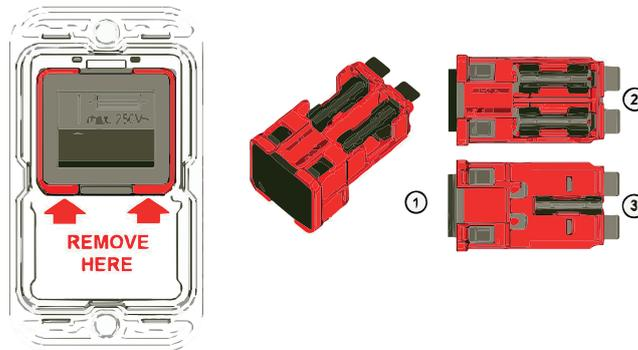
Eine zusätzliche Sicherungsmarkierung am Schalter kennzeichnet die Sicherungshalter hinter dem Schalter. Der rote Rahmen zeigt den Umriss der entfernbaren Einheit.
