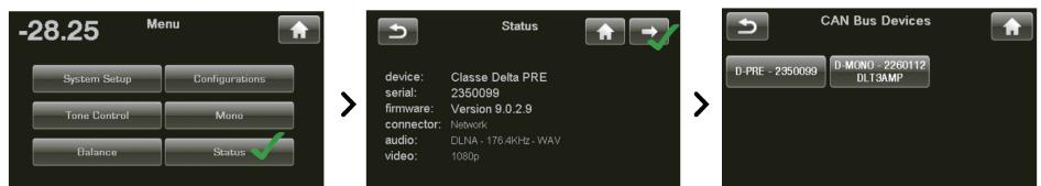
CAN-Busデバイス画面でユニットを選択すると、そのユニットがターゲットユニットとして識別されます。ターゲットユニットの前面LEDまたはメーターライトが点滅を開始します。(CAN-Busへのアクセスに使用しているユニットは除きます。)
