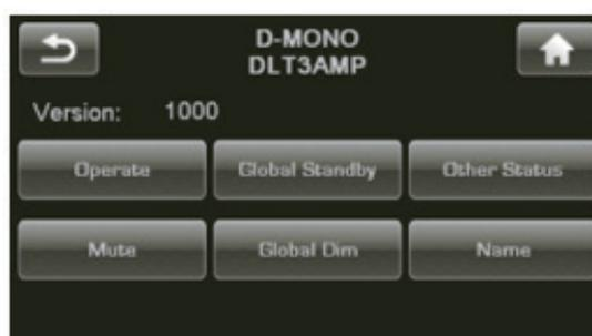
Le modèle, le nom et le numéro de version du micrologiciel seront affichés sur la page du bus CAN de l'appareil cible.
